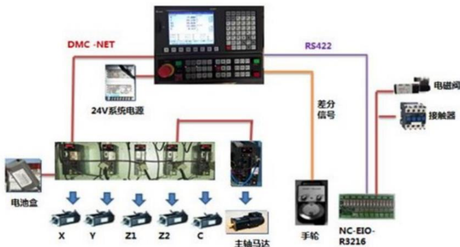
图17：数控系统是机床最核心的控制部件
