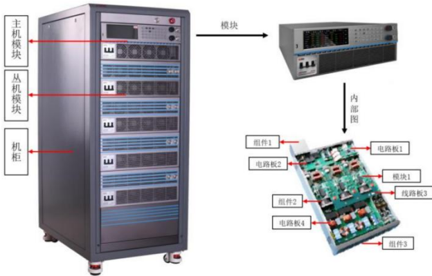
图 85：主要由通用模块组成的精密测试电源
