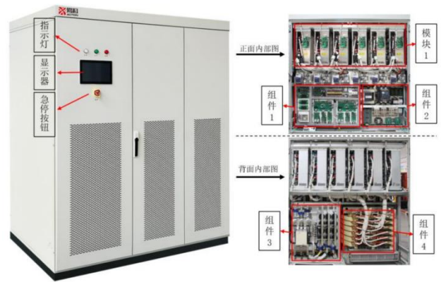
图 86：由模块及相关组件共同构成的精密测试电源
