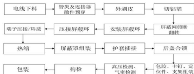
图64: 汽车高压线束生产工艺流程
