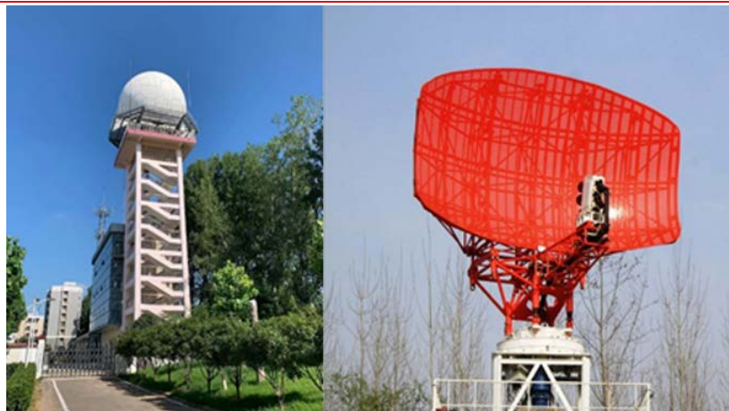
图表4：SCR-23 L 波段远程空管一次监视雷达
