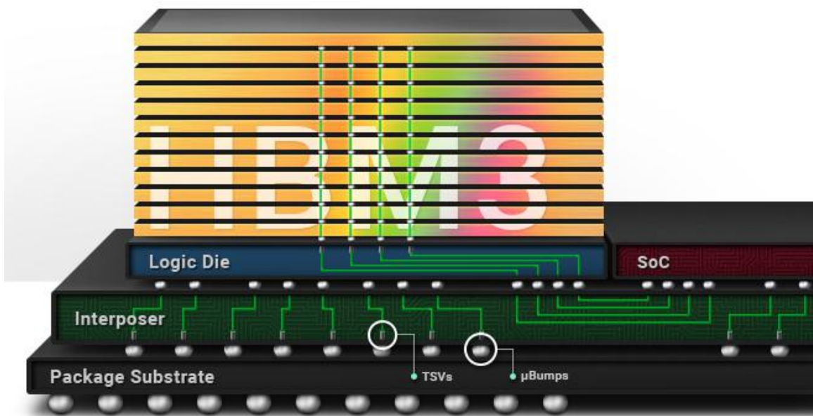
图 19: 海力士 HBM 内存堆叠采用 3D 封装技术
