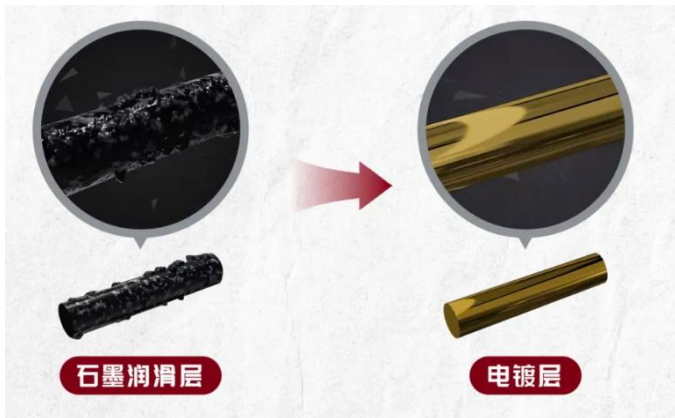
图表：“钨丝冷拉”工艺使用电镀层取代石墨颗粒润滑层
