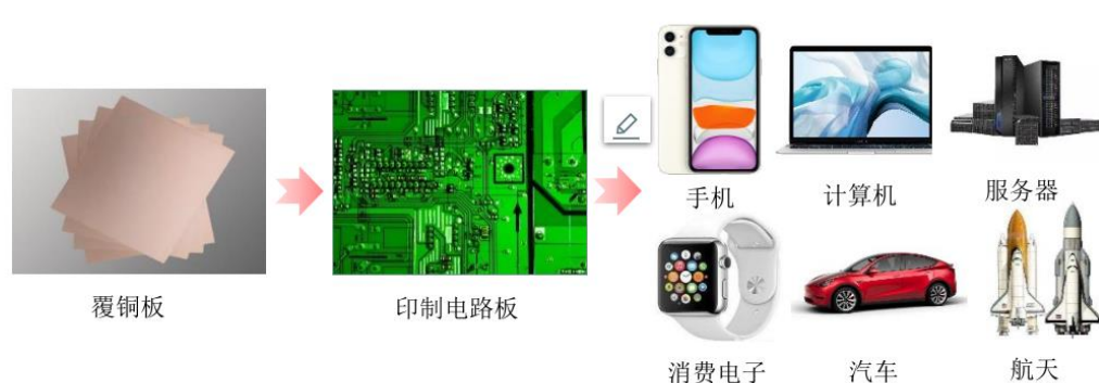
图表13：覆铜板是PCB板的核心基材
