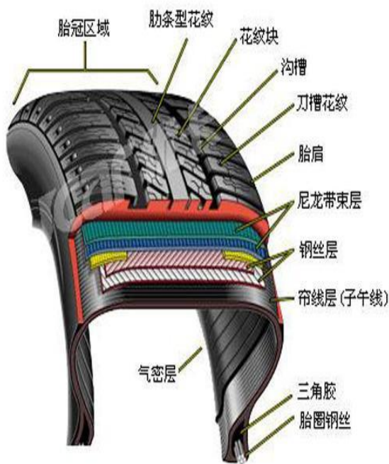
图表1：轮胎结构图
