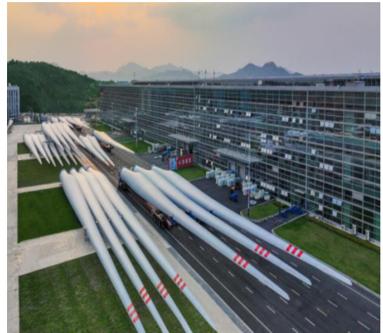
图30: 131 米陆上风电叶片于巴彦淖尔零碳数智产业园下线
