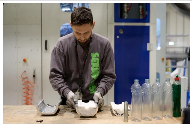
图 5：Serioplas 的 PET 预生产样品瓶和模具
