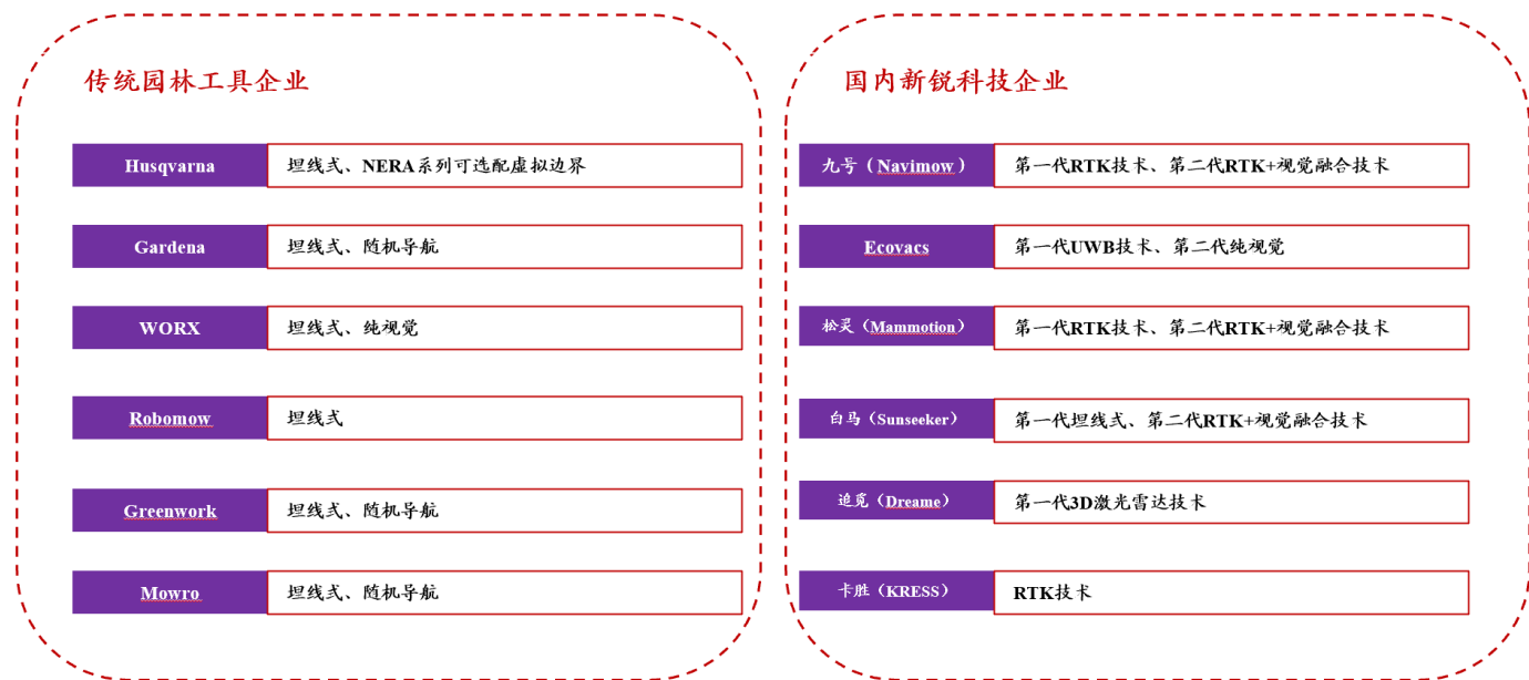
图8: 无埋线式割草机器人以中国新锐科技企业为主, 技术路径分为 UWB、纯视觉、RTK、3D 激光雷达等
