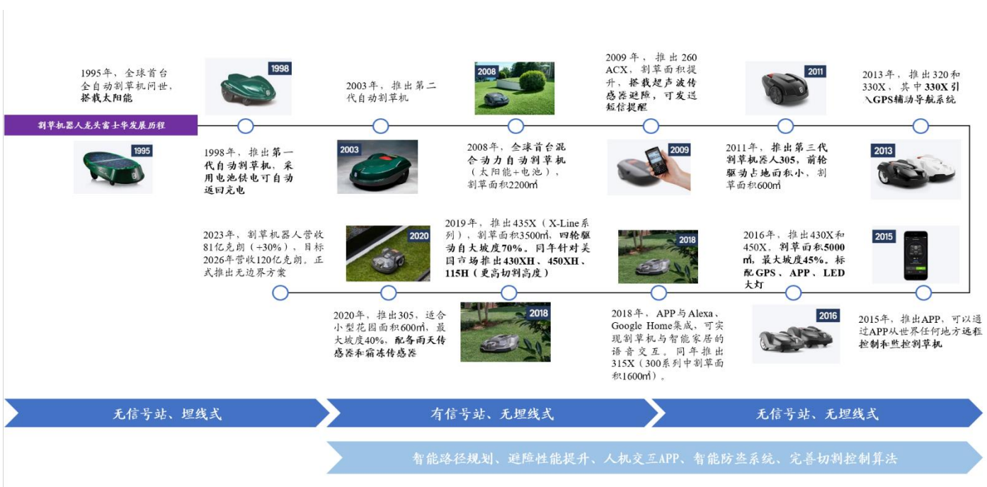
图7：割草机器人市场正逐步由早期埋线式向无线式迭代，无线式割草机器人在导航、避障、防盗等方面亦有升级
