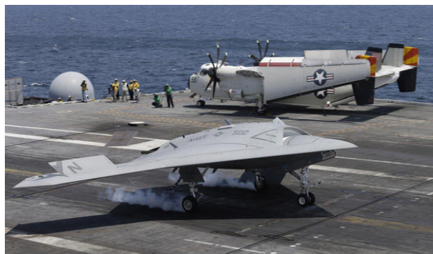
图 8：X-47B 无人机成功降落航母甲板
