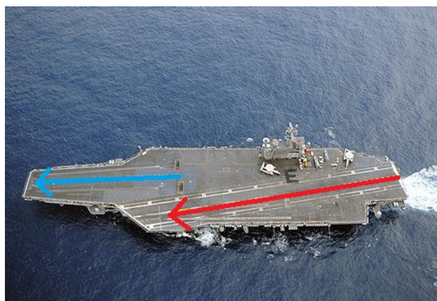
图 6：采用斜角甲板设计分开航母起飞和降落区
