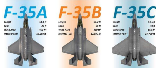
图 15：F-35C 拥有更大的展弦比和机翼面积
