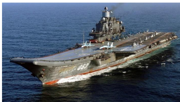
图 36：采用滑跃式跑道的“库兹涅佐夫”号航母
