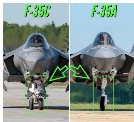
图 17: F-35C 强化设计的前起落架
