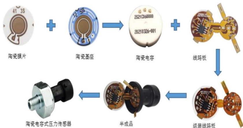
图：陶瓷电容式压力传感器工艺路线图
