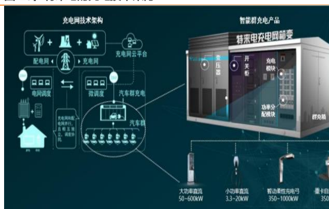
图 10：特来电的充电技术架构
