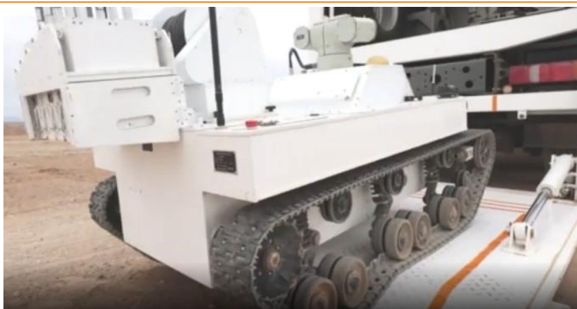
图 21：我火箭军多功能智能机器人清除高危辐射源
