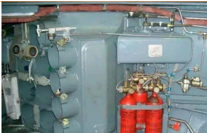
图 15：俄 T-80 坦克内部，红色金属罐内装有灭火剂
