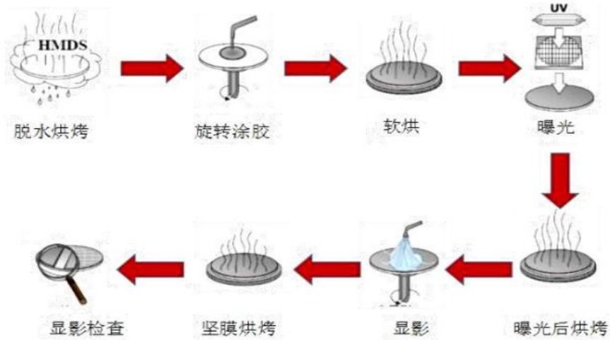
图表 16: 光刻工艺流程
