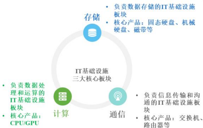
图29 IT 基础设施总体分为计算、存储和通信三大板块
