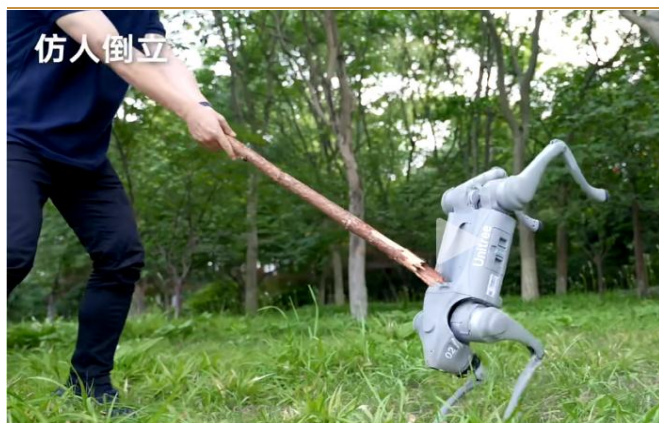
图 4：宇树科技四足机器人能够在极端扰动下恢复正常
