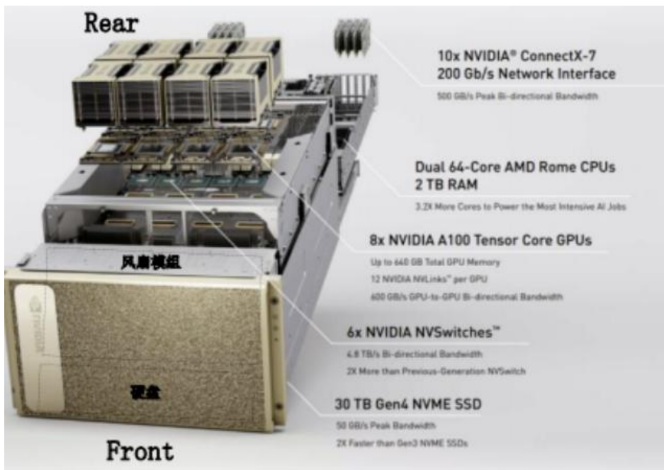
图：英伟达DGX A100服务器结构示意图
