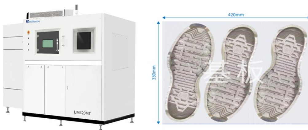
图 21：容智三维 UM420MT 一次可成型三支鞋模
