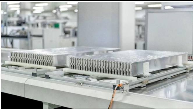
图25: 比亚迪第二代刀片电池的能量密度有望达到 190Wh/kg
