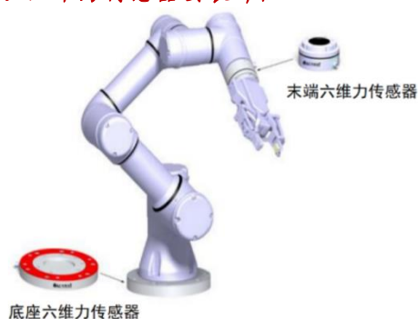
图表 50：六维力传感器安装部位
