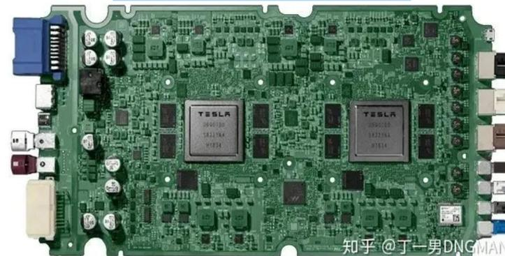
首次采用**特斯拉自研的自动驾驶芯片**，抛弃英飞凌/英伟达的产品，自研高度集成的SoC+MCU芯片
