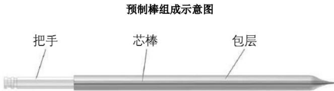
图 28：光纤预制棒组成示意图
