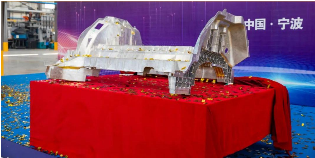
图 41：7200T 压铸机生产的超大型结构件
