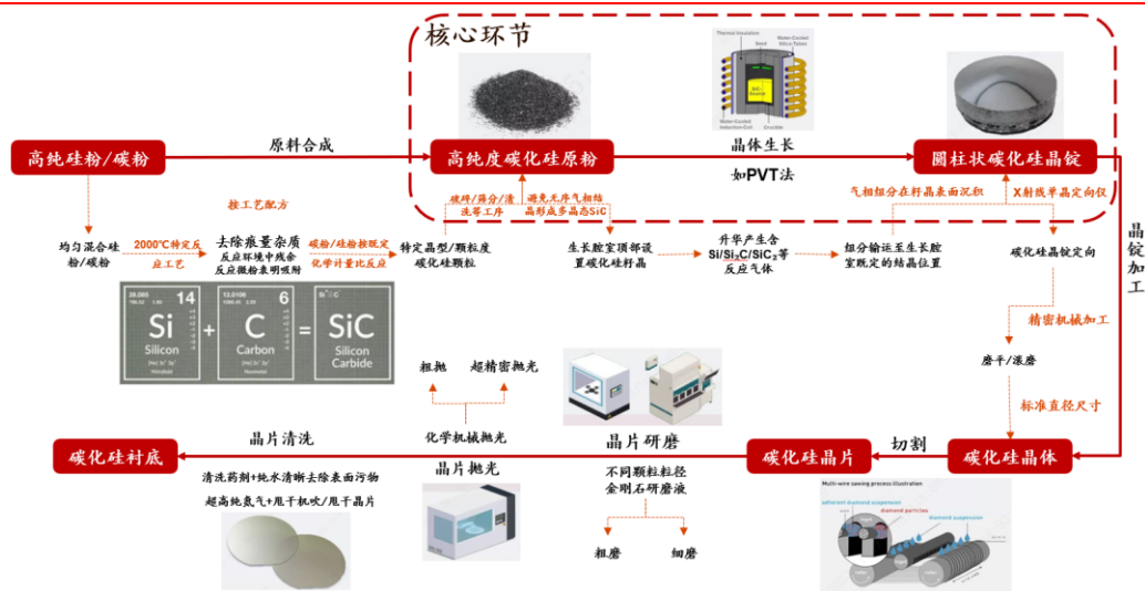
图 13：碳化硅衬底的制备流程概览
