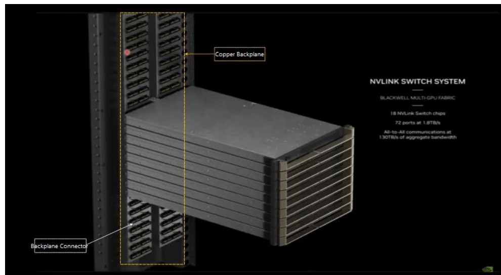
图：NVIDIA GB200 NVL72 铜缆背板和背板连接器原理图
