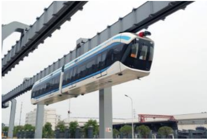
图61：中铁工业研制出悬挂式单轨新型轨道交通车辆
