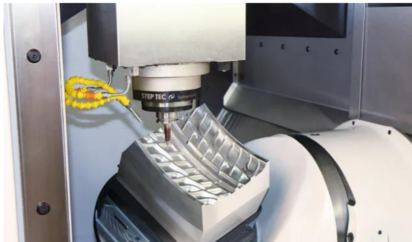
图24：精密雕刻生产轮胎模具对机床加工能力要求高
