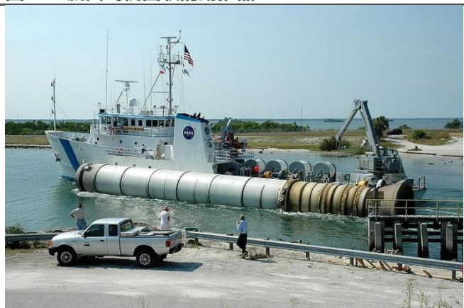
图28：航天飞机回收的助推器
