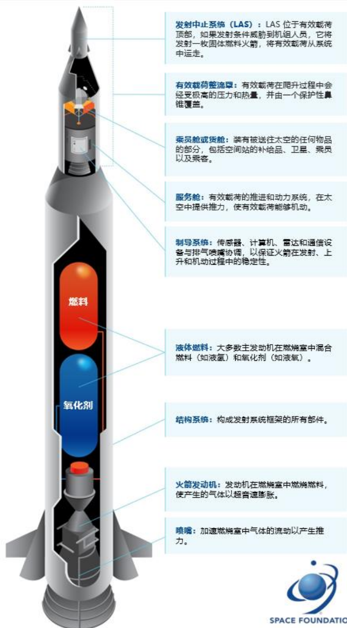
图8：液体火箭结构示意图
