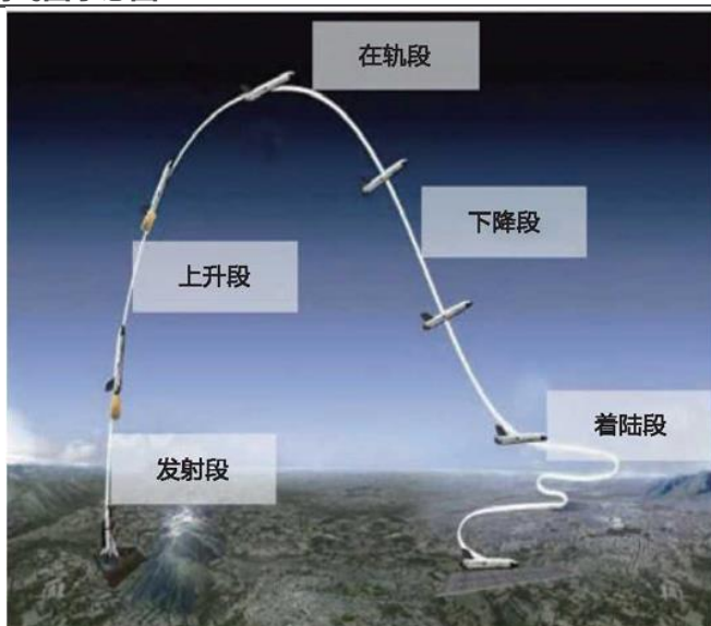
图29：翼滑飞回示意图
