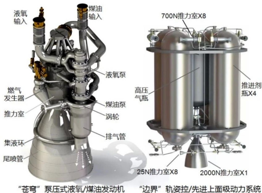
图13：液体火箭发动机结构示意图
