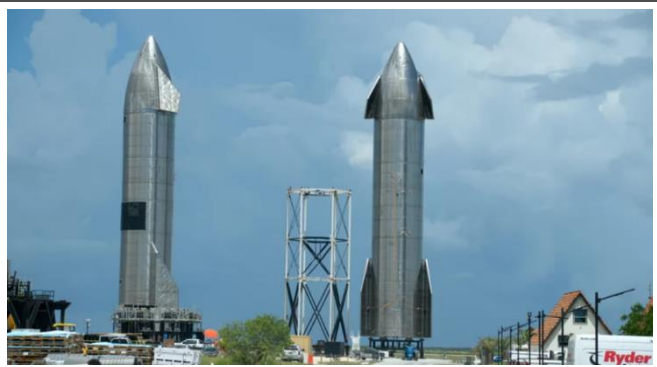
图9: 星舰两级火箭的主体采用不锈钢制成
