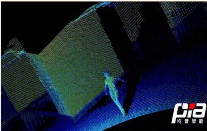
图 12: 均普智能机器人用激光雷达点云
