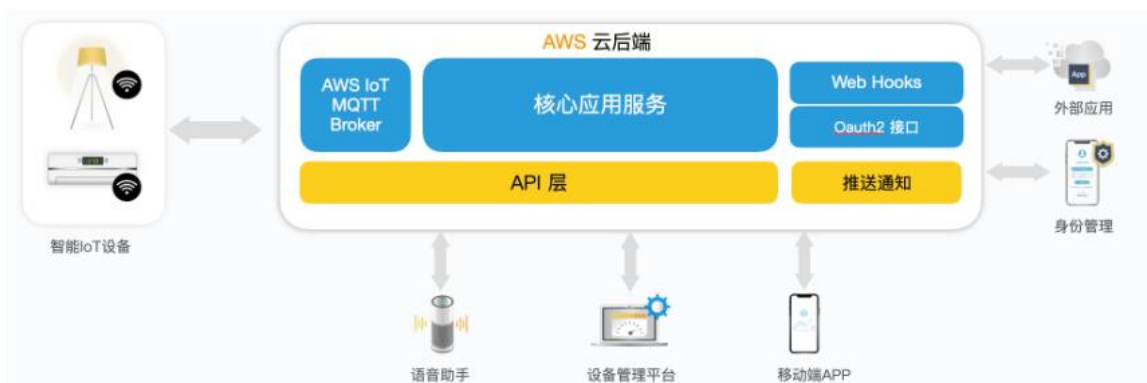
图表 34: ESP Rainmaker 架构图
