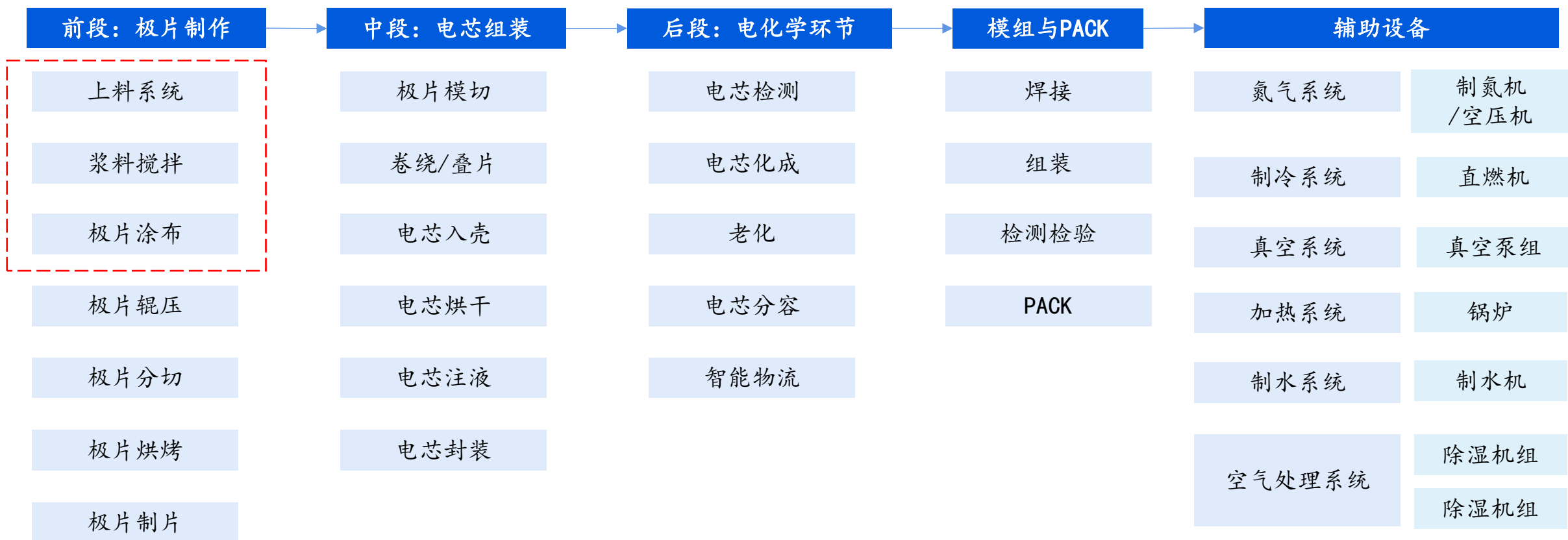
图表：锂电池生产工艺流程图
