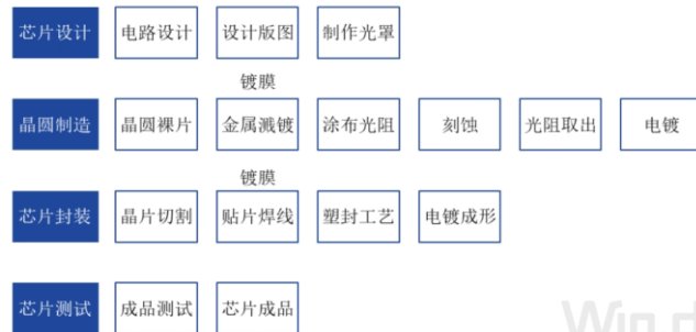
图41：半导体集成电路用溅射靶材主要用于芯片封装与晶圆制造
