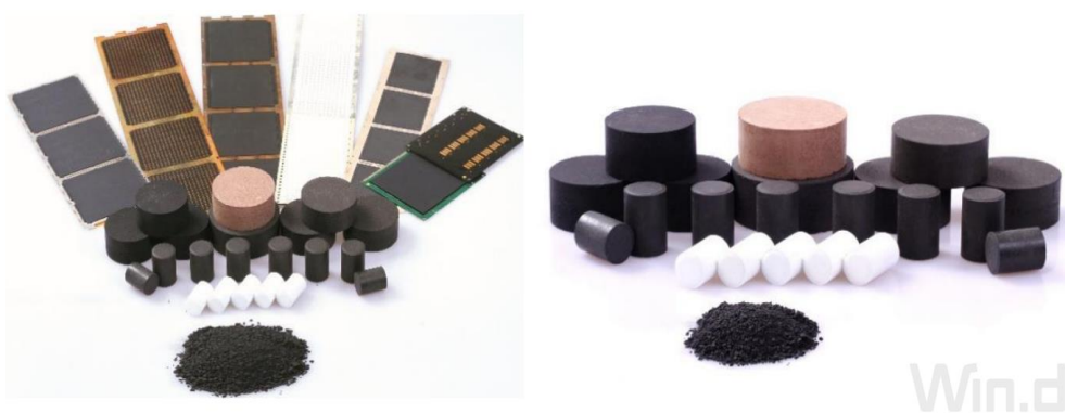
图68：环氧塑封料是一种以环氧树脂为基础的复合材料
