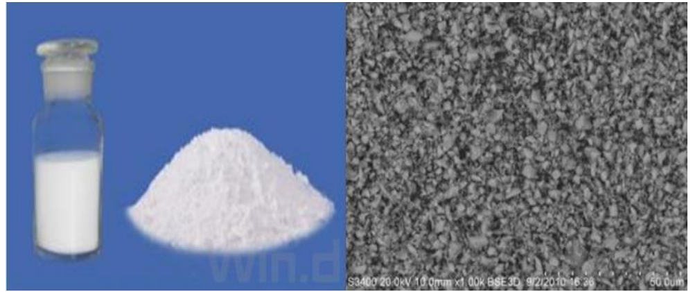
图73：角形硅微粉产品外观及颗粒形貌如下图所示
