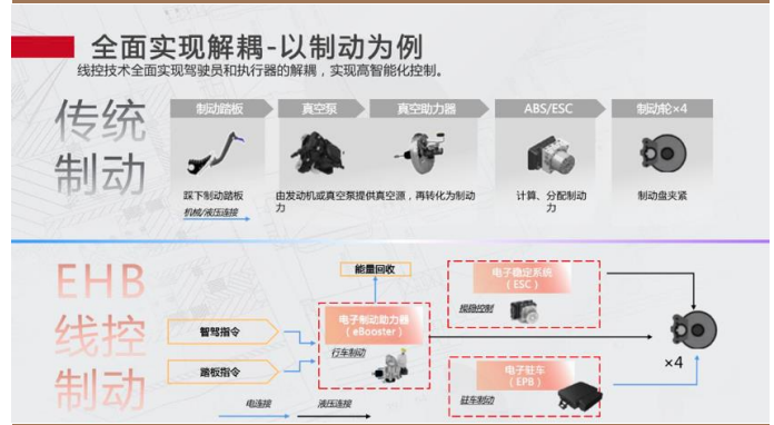
图 39：千顾科技提出的从传统制动到 EHB 线控制动
