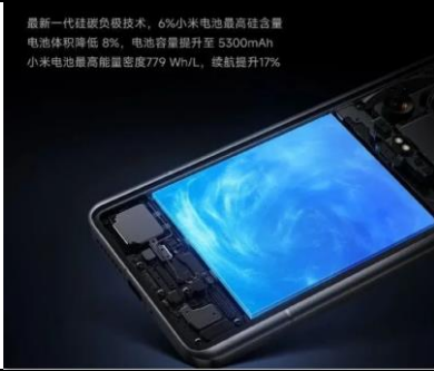
图 28: 小米 14 Ultra 采用最新一代硅碳负极技术
