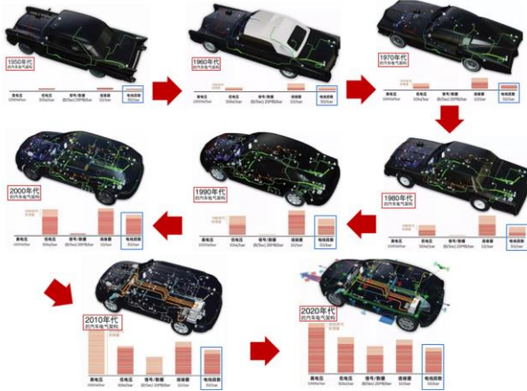
图 17：汽车电气架构演变带动汽车线束用量增加
