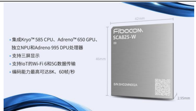
图32：广和通 AI 模组 SCA825-W 可提供 15TOPS 算力
