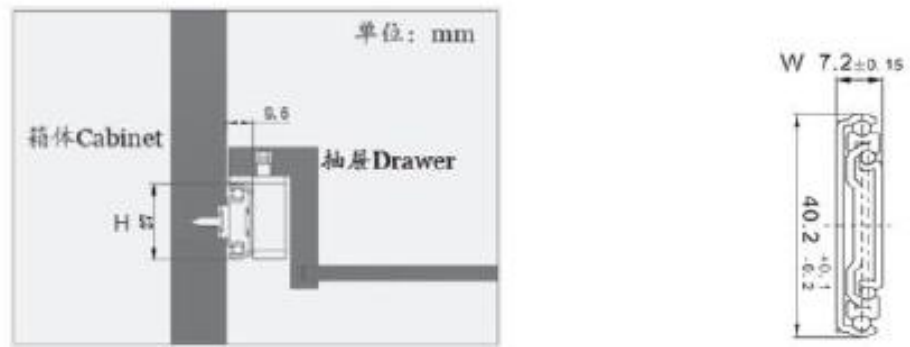
图2：家电滑轨以高度分类（图左），服务器滑轨以厚度分类（图右）
