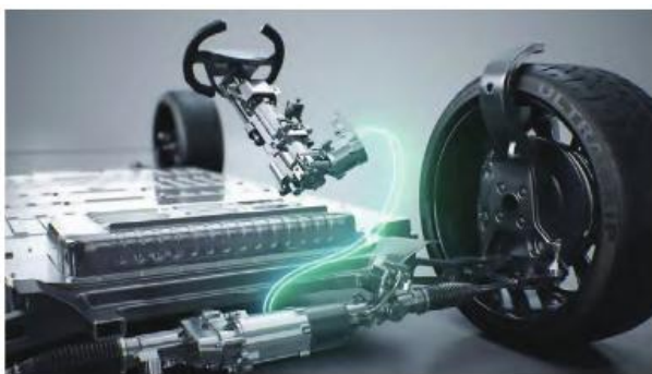
图59：线控转向系统示意图
