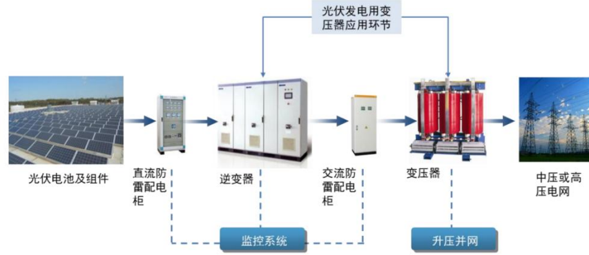
图表 30: 光伏升压变应用原理图
