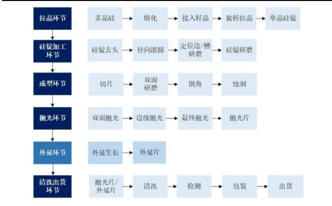
图表 18：半导体抛光片、外延片工艺流程
