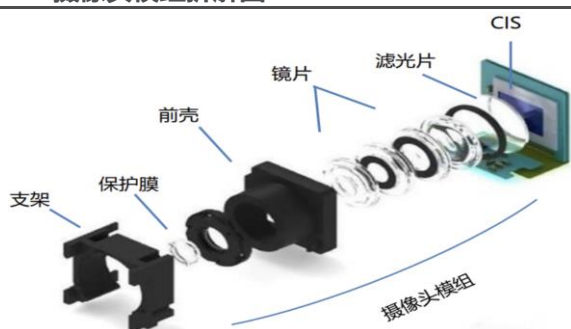
图14：摄像头模组拆解图
