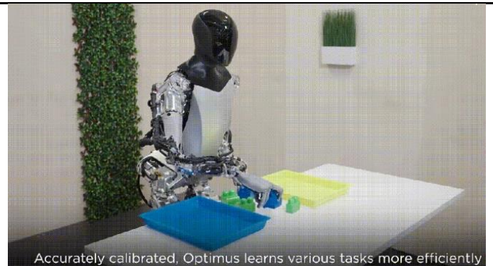
图 20: Optimus 完全自主按颜色对色块进行排序
