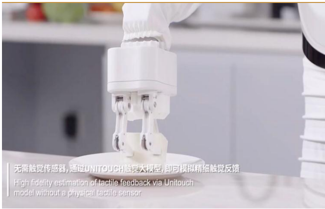
图 4: Wanda 可以借助 UniTouch 触觉模型感知不同物体
