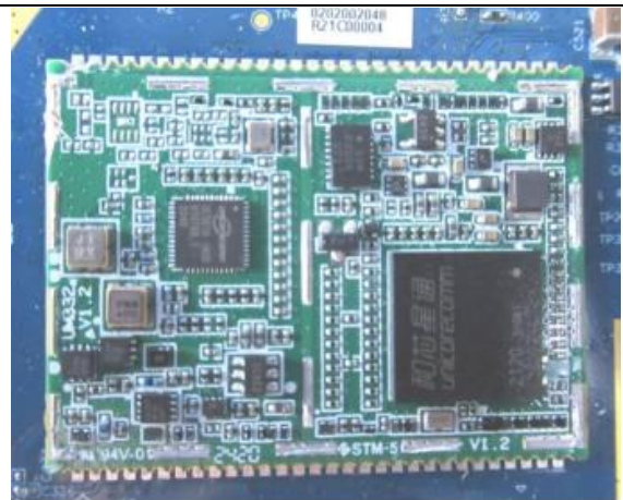
图表 20 高精度 GNSS 接收机拆解—GNSS 模块
