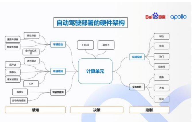
图表 6 百度 robotaxi 自动驾驶硬件架构
