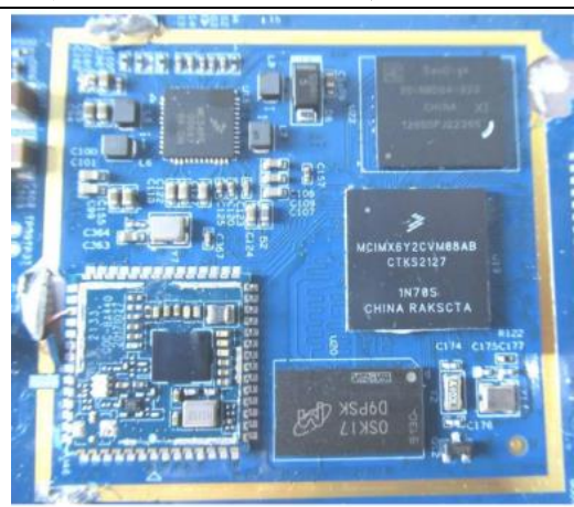
图表 22 高精度 GNSS 接收机拆解—主处理模块
