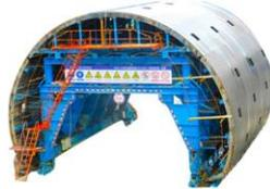
衬砌台车主要应用于隧道内壁的二次衬砌，二次衬砌成型后即形成隧道投入使用的内墙面（隧道闭环中的重要受力部分），隧道（隧洞）衬砌台车包含集中控制系统，具备自动就位、自动脱离、自动行走的功能，能够高效率地完成施工作业。
