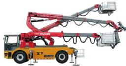
集拱架安装、钢筋网铺设、爆破装药等多种高空作业功能为一体，可适用高速公路、铁路全断面法、台阶法的多榀拱架预制分段、多榀拱架预制折叠、单榀拱架折叠作业方案。
