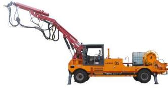
湿喷机主要应用于隧道开挖后的初期支护，利用作业机械手和混凝土喷射系统，通过操作人员遥控操作，将掺和了速凝剂的特制混凝土通过高压喷射到刚开挖的隧道洞壁上，并迅速固化，以防止隧道塌方和渗水，保护隧道施工顺利实施。
