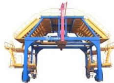
适用于双线铁路、双线公路、单线铁路、三线公路隧道的挂布及辅助钢筋绑扎作业。
