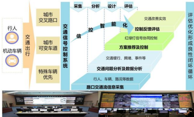
图29. 公司交通信号控制系统运行示意图
