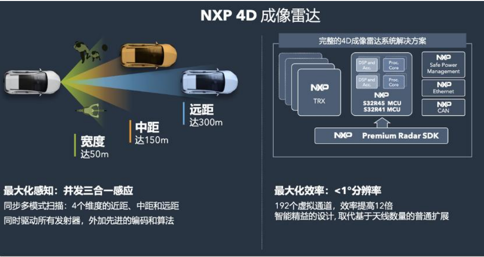
图 ADS 3.0使用4D毫米波雷达
