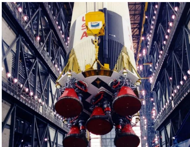
图8: 土星V号 S-IC 级和五台 F-1 发动机
